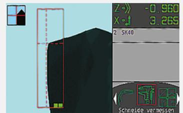
Dynamisches Fadenkreuz für automatisches, bedienerunabhängiges und schnelles Messen
