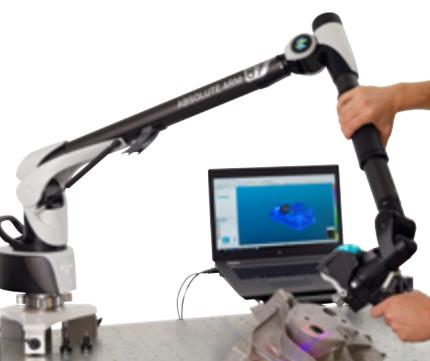
Der Messarm findet seine Verwendung bei der Vermessung sperriger Teile, wie auch bei der Bauteilvermessung direkt an der Maschine.
