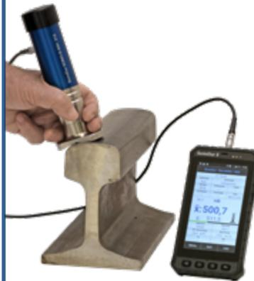
Zur mobilen Überprüfung der Härte an Werkstoffen.
