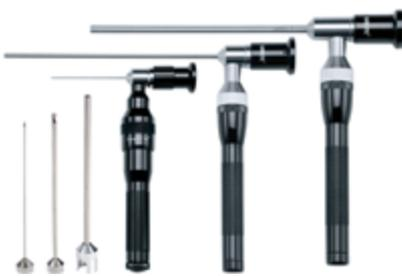
Zur zerstörungsfreien Prüfung bzw. visuellen Sichtprüfung an schwer zugänglichen Stellen.
