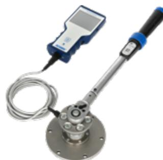
Zur mobilen und stationären Kraft- und Drehmomentmessung.
