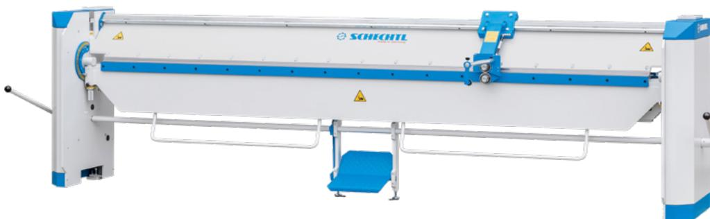
Das Modell HA ist eine manuelle Schwenkbiegemaschine zum Biegen von Stahlblechen bis max. 3 mm. Die Kombination von massiven Maschinenelementen in Schweißkonstruktion und einem ausgeklügelten Federsystem als Gewichtsausgleich für Ober- und Biegewange macht das Modell HA zu einem „Kraftpaket“, ohne dass der Bediener an seine Kraftreserven gehen muss.
