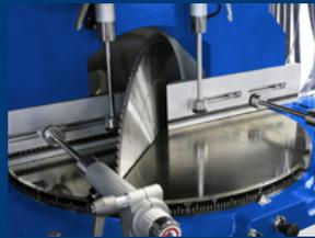
Stufenlose Verstellung des Gehrungswinkels
