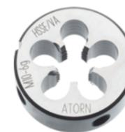
Ausführung: rechtes Schneideisen Tol. 6g mit Schälanschnitt (ab M2) und nitriert, vorgeschlitzt und 2,0-Gang Anschnitt
