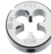
Ausführung: rechtes Schneideisen M1 bis M1,4 = Tol. 6h, M1,6 bis M36 = Tol. 6g mit Schälanschnitt (ab M3), vorgeschlitzt und 1,75-Gang Anschnitt
