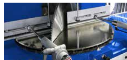
Stufenlose Verstellung des Gehrungswinkels
