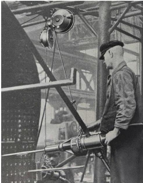
Die praktischen AUTOSTAT-Balancer von HAHN+KOLB bewähren sich seit 90 Jahren in Produktion und Montage und ermöglichen den ergonomischen Gebrauch von handgeführten und schweren Werkzeugen sowie Elektrogeräten am Arbeitsplatz (Katalogbild, ca. 1935).
