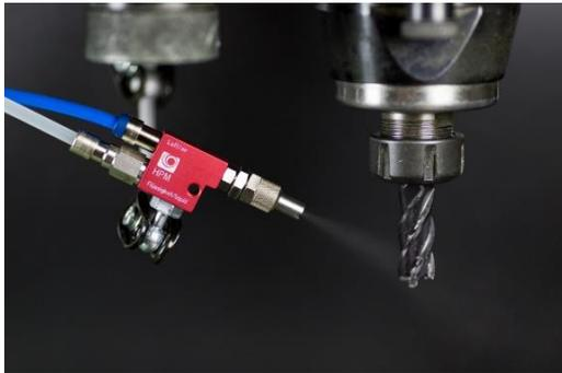
Bei der Minimalmengenschmierung sprüht eine Düse geringe Mengen des Kühlschmierstoffs als feinen Nebel direkt auf das Werkzeug.
