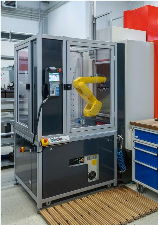
Bestehende Prozesse verbessern: Das Baukastensystem der modularen Roboterzelle passt sich jedem Produktionsspektrum an.
