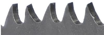
Die positive Zahngeometrie des Sägebands ermöglicht höhere Schnittgeschwindigkeiten.
