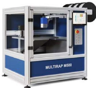
Der neue industrielle 3D-Drucker Multirap M500 druckt schnell hochwertige Prototypen und Kleinserien mit bis zu vier unterschiedlichen Kunststoffen oder Farben.
