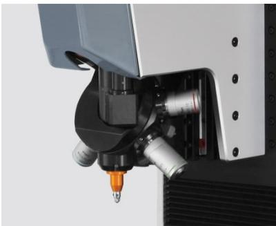
Dank eines 6-fach-Werkzeugwechslers sind mit dem CHD Master Plus Mehrfachmessungen, Einzel- und Reihenmessungen sowie CHD, NHD und SHD möglich.
