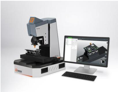
Gestochen scharfes Probenbild und Mehrfachproben: Dies zeichnet das neue Mikrohärteprüfgerät CHD Master Plus von Qness aus.
