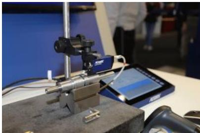
Über einen Barcode-Scanner werden bereits hinterlegte Messprogramme mit allen bauteilrelevanten Parametern aufgerufen und gestartet.
