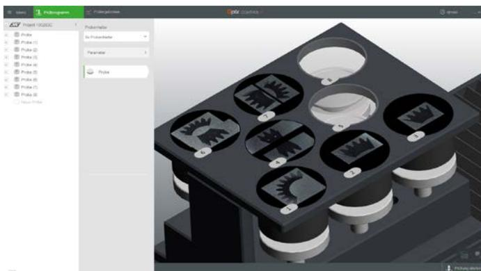
Mit der Software Qpix Control2 lassen sich mehrere Proben gleichzeitig verwalten; sogar bei verschiedenen Probesteilen in einer Bettung. Dabei simuliert die neue Härteprüfsoftware die Prüfumgebung auf dem Gerät originalgetreu und in 3D.
