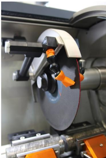
Für das saubere Bearbeiten der Werkstücke – sowohl beim Trennen als auch beim Schleifen – kommen Korund-Trennscheiben CorCut mit einem Durchmesser zwischen 254 und 432 mm zum Einsatz.
