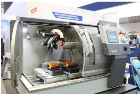
Eine große Schiebetür sowie eine nach hinten schwenkbare Seitentür garantieren eine optimale Zugänglichkeit für sämtliche Reparatur- und Servicearbeiten.
