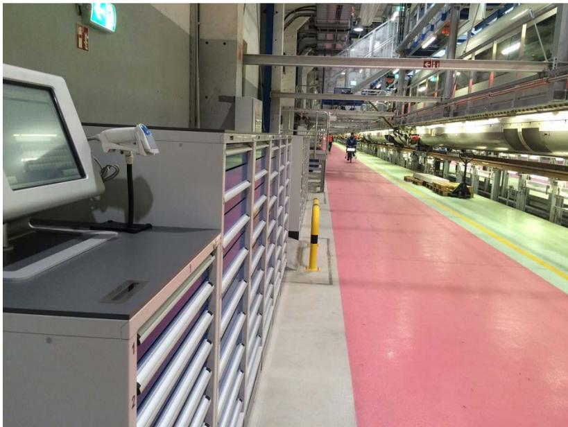
HAHN+KOLB lieferte für die neue Instandhaltungshalle der DB Fernverkehr AG im Werk Berlin-Rummelsburg insgesamt 15 Werkzeugausgabesysteme vom Typ HK-MAT.
