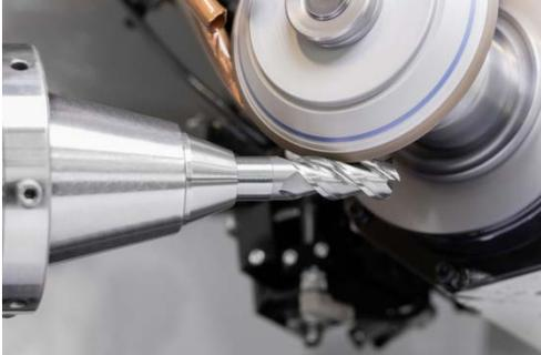
Die Zerspanungswerkzeuge werden auf modernsten 5-Achsen-CNC-Schleifmaschinen geschärft. Das verringert den Materialabtrag und bietet höchste Standzeiten der aufbereiteten Werkzeuge.
