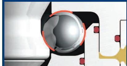
Die Kugeln werden formschlüssig von 3 Seiten umschlossen. Die Kräfte wirken gleichmäßig auf die Kugeln und werden optimal verteilt.
