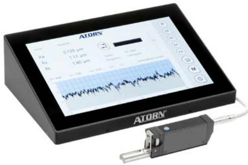
Das ATORN Rauheitsmessgerät easyROUGHNESS unterstützt beim Messen der Rauheit technischer Oberflächen.
