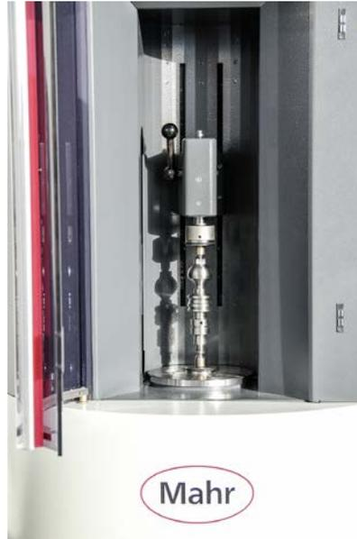
Das optische Wellenmessgerät MarShaft SCOPE 250 plus von Mahr kommt direkt in der Fertigung zum Einsatz. Es scannt in Höchstgeschwindigkeit die Oberflächen rotationssymmetrischer Bauteile und produziert dabei bis zu 120 Bilder in der Sekunde.
