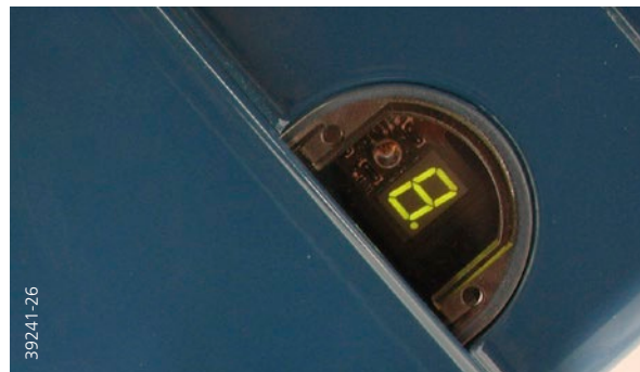
Anzeige für Betriebsstundenzähler und Betriebszustände
